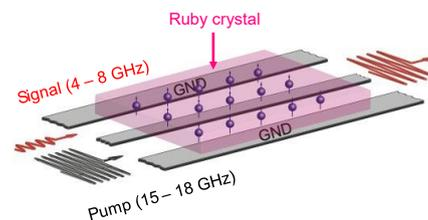
図 2. 進行波メーザー増幅の模式図。広帯域の 2 次元マイクロ波導波管がスピンと相互作用する
