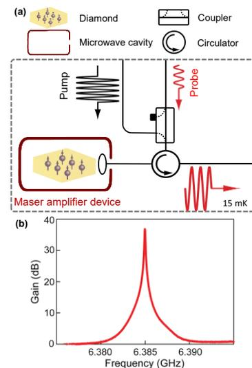
図 1. ミリケルビンでのメーザー増幅の最初のデモンストレーション。(a) セットアップ概略図、(b) 得られた利得（約 36 dB）
